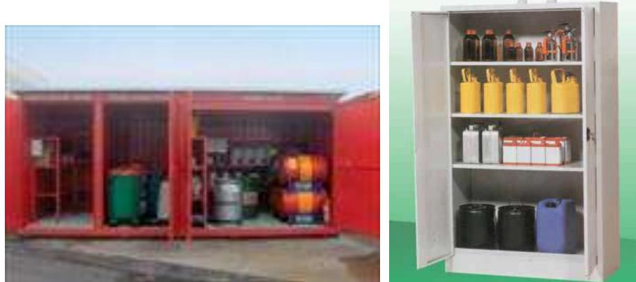
Plinske boce (acetilen i kisik u bocama za autogeno zavarivanje), boce butan-propana moraju se čuvati u tipskim atestiranim nadstrešnicama, i moraju biti osigurane od prevrtanja.
